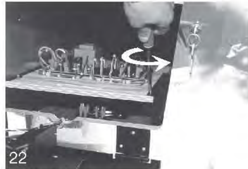
22 EXTRACCION DE C.P.U. C.P.U. WAY OUT.
